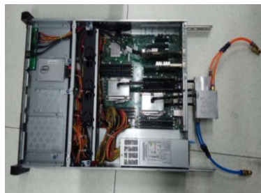
图2 中国移动呼和浩特冷板式液冷测试
