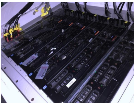
图3 中国移动 5G 基站单相浸没式液冷试点
